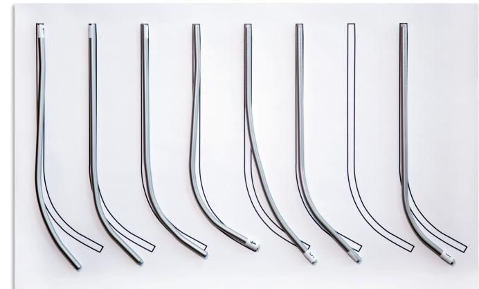
**Forte disparité :** comparaison qualitative entre la forme réelle de la tige modèle et le cintrage manuel réalisé par des chirurgiens et internes lors d'un atelier<sup>1</sup>
